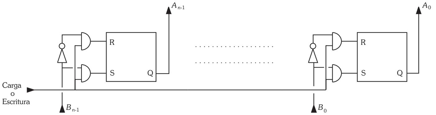
Figura 3.1. Registro de carga paralela de  $n$  bits.
