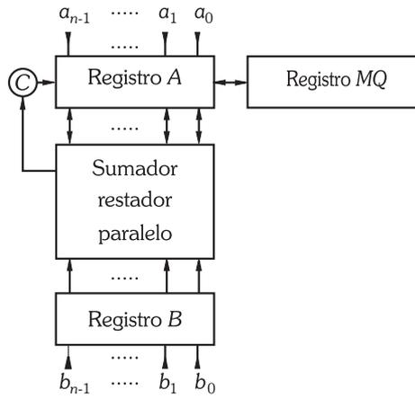
Figura 5.1. Hardware para ejecutar los algoritmos aritméticos.
